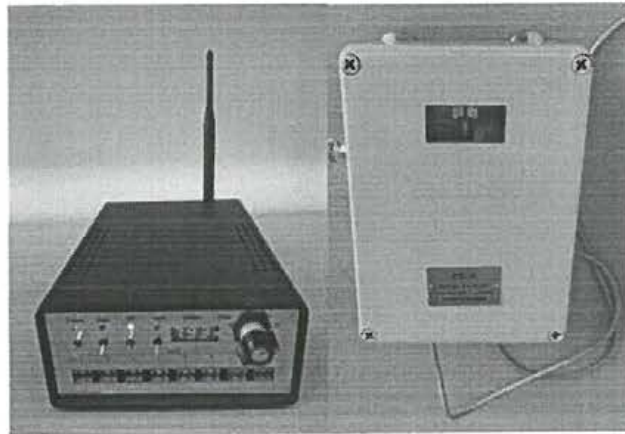
Նկար 6. Ժամանակակից սեյսմիկ կայան միկրոսեյսմիկ տատանումների գրանցման համար
